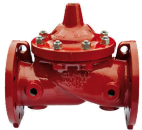
Basisventil DN 32 – DN 1400 PN 10 – 4B Gehäuse: duktiles Gusseisen EN-GJS-400-15 Oberflächenschutz: EKB rotbraun oder blau Einbauteile: Edelstahl Membrane: EPDM Pilotventil: Bronze
