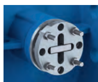
Verriegelungsflansch verriegelt in Position „Scheibe offen“
