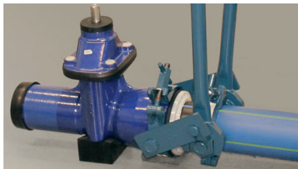
8. Rohr durch den NOVO-Grip® III-Ring so weit in die Muffe einschieben, bis es am Dichtring zentrisch anliegt. Bei der Montage Abwinkelung vermeiden!
