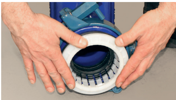
3. NOVO-Grip® III-Ring in die Vorkammer einlegen.
