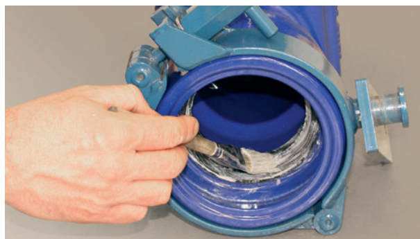
7. GKS-Dichtung mit Gleitmittel bestreichen.
