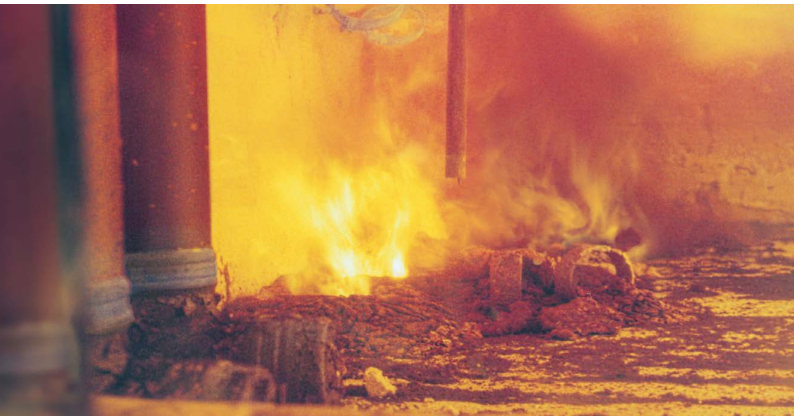
Guss- und Kunststoffrohre im Brandversuch – im Hintergrund abgebrannte Kunststoffabflussrohre, im Vordergrund unversehrte Gussabflussrohre.
